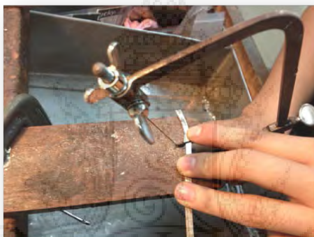
ภาพประกอบ 31 การตัดและฉลุลายลงบนโลหะตามแบบ
