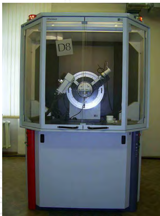
รูปที่ 3.27 เครื่องวิเคราะห์หาล่องค์ประกอบของโลหะ (X – Ray Diffractometer)
