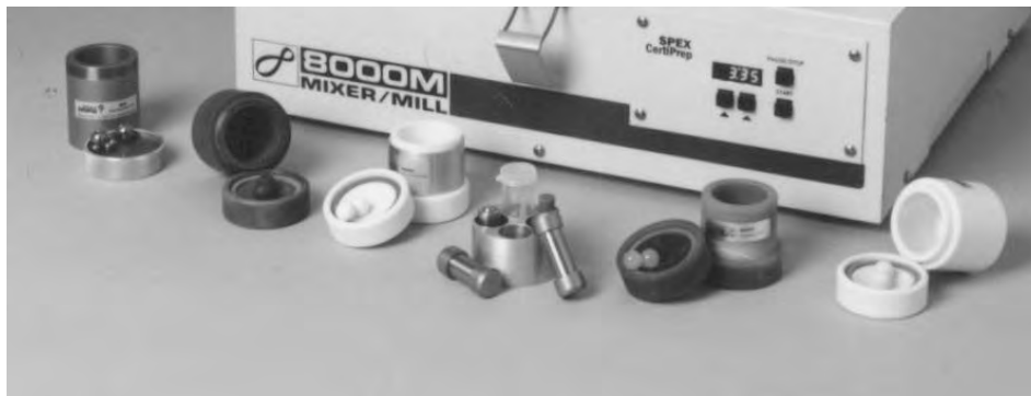
รูปที่ 2.8 ชุดหม้อบดทั้งสแตนคาร์ไบด์ ซึ่งประกอบด้วย หม้อบดทั้งสแตนคาร์ไบด์ ฝาปิด ลูกบอลและแหวนรองป้องกันการรั่วซึม [41]
