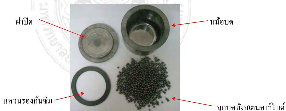
รูปที่ 3.37 เตรียมวัสดุและอุปกรณ์สำหรับการบด
