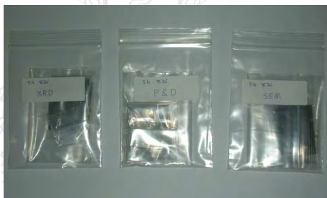
รูปที่ 3.48 โลหะผงบรรจุถุงสำหรับนำไปทดสอบสมบัติและคุณลักษณะต่างๆ
