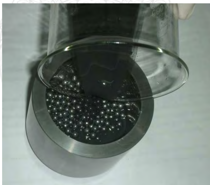
รูปที่ 3.39 การเทตะกอนโลหะผงลงในหม้ออบ
