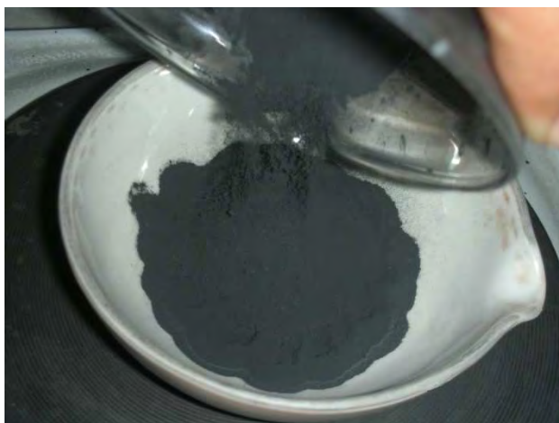
รูปที่ 3.45 โลหะผงทั้งสแตนคาร์ไบด์ที่ผ่านการให้ความร้อนบนเตาไฟฟ้า
