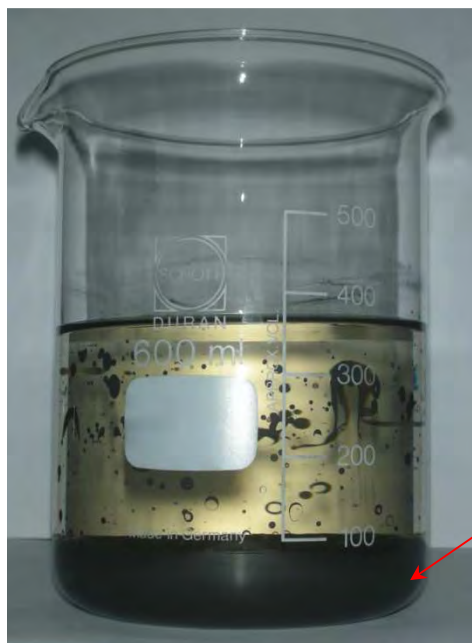
รูปที่ 3.43 การตกตะกอนของสารละลาย
