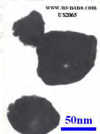
รูปที่ 3.5 ผงทังสเตนคาร์ไบด์ขนาด 50 นาโนเมตร [33]
