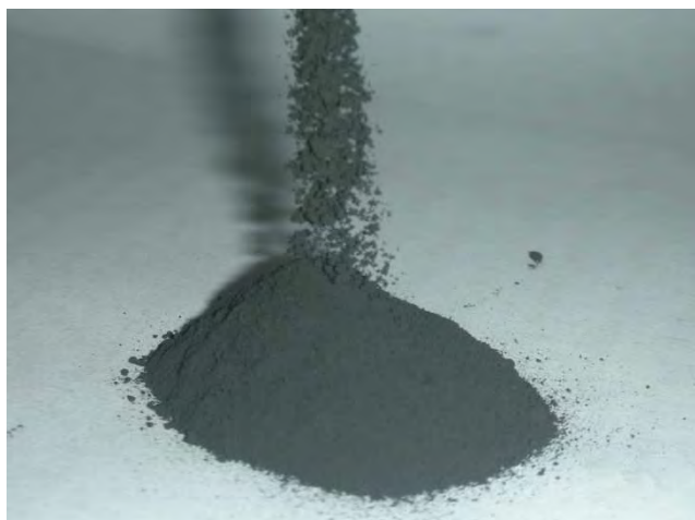
รูปที่ 3.47 โลหะผงทั้งสแตนคาร์ไบด์ที่ได้จากกระบวนการผลิต
