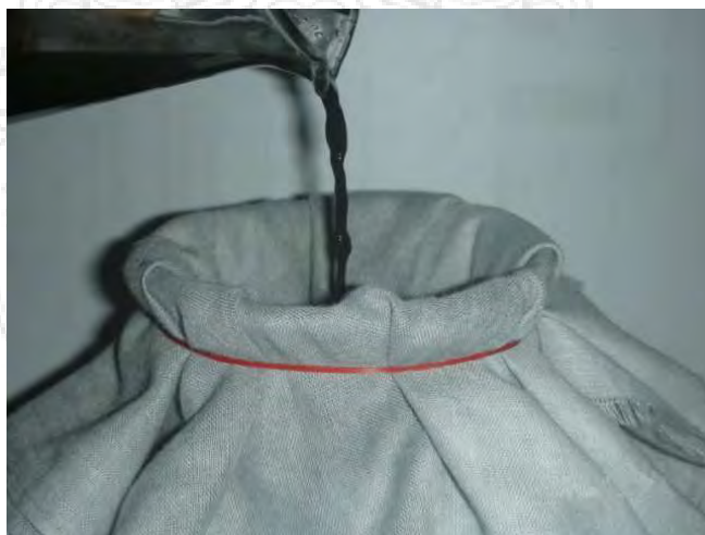
รูปที่ 3.42 การกรองสารละลายผ่านผ้ากรอง
