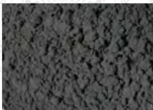
รูปที่ 1.5 ทังสเตนคาร์ไบด์นำเข้าบริษัท Sichuan Western Minmetals รหัส ZK30 \mu F: 10%Co ขนาด 0.6-0.8 \mu m [24]
