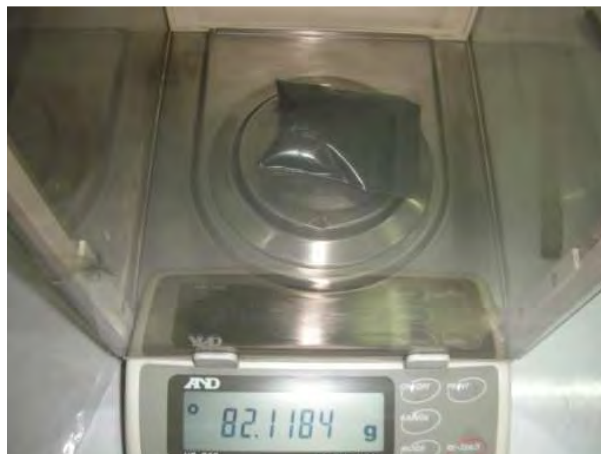
รูปที่ 3.34 การตรวจสอบน้ำหนักโลหะผง
