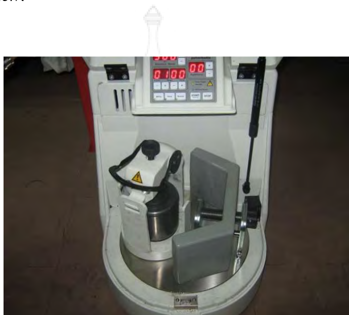
รูปที่ 3.40 การจับยึดหม้อบดและการเตรียม เครื่องบดโลหะผง
