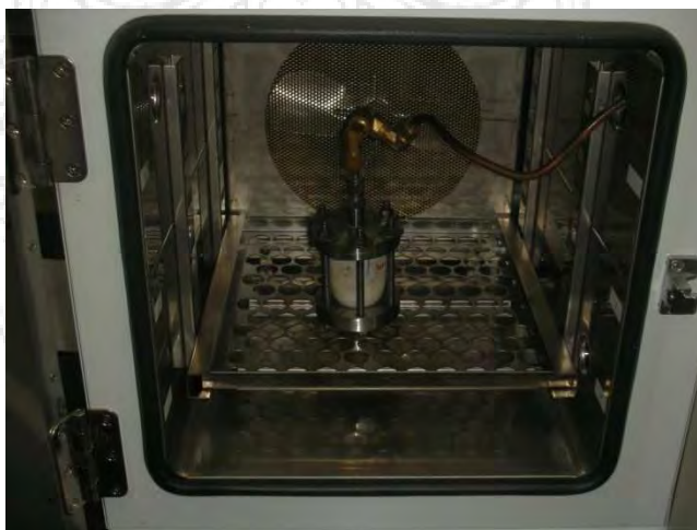
รูปที่ 3.46 การติดตั้งถ้วยอบภายในเตาสูญญากาศ
