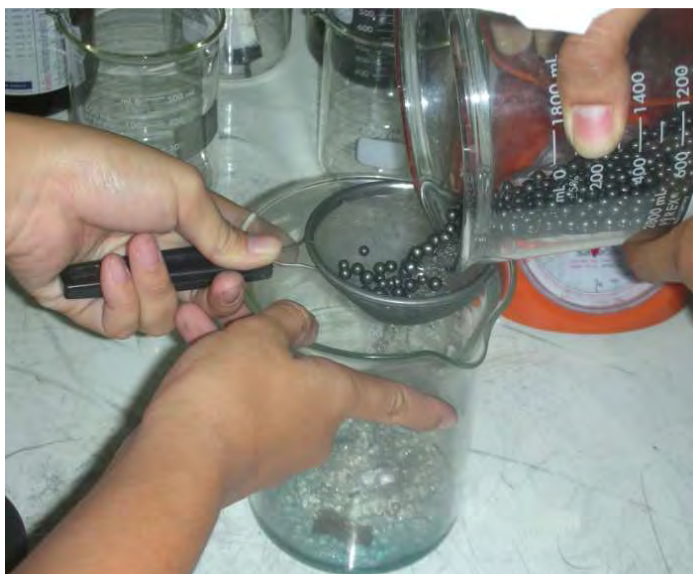
รูปที่ 3.38 การกรองผงโลหะและแยกลูกบิดผ่านตะแกรงหลังทำความสะอาดด้วยเอทานอล
