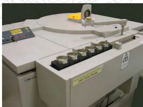
รูปที่ 3.29 เครื่องวิเคราะห์ X-ray fluorescence spectrometer, Philips PW-2404, 4kW
