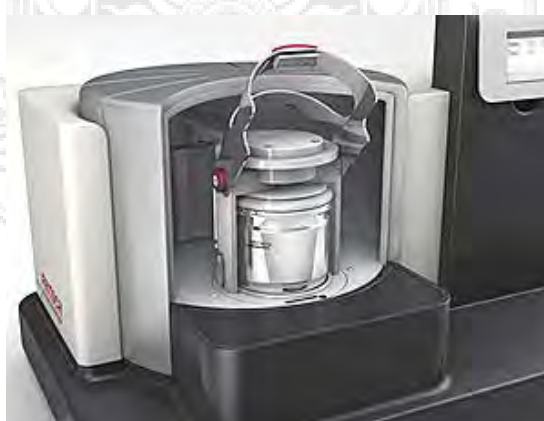
รูปที่ 2.7 ลักษณะเครื่องบดพลังงานสูงทำการบดด้วยลูกบอลแบบแพลเน็ต [42]
