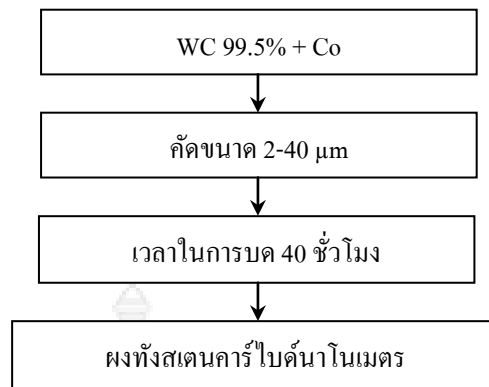
รูปที่ 2.10 ขั้นตอนการผลิตโลหะผงทั้งสเดนคาร์ไบด์นาโนเมตร [10]
