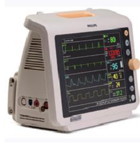
รูปที่ 1 เครื่องตรวจติดตามการทำงานของหัวใจและแสดงตำแหน่งในการวัดสัญญาณไฟฟ้ากล้ามเนื้อผู้ป่วย
