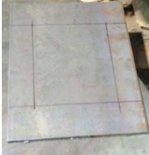
ภาพที่ 3-6 แสดงแผ่นเหล็กที่ตัดแล้วทำเครื่องหมายเพื่อตัดช่องประตู
