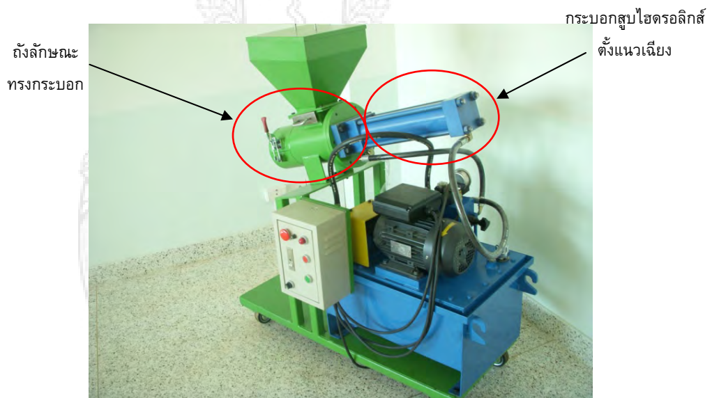
ภาพที่ 3-1 แสดงเครื่องบีบเยื่อใบสับปะรดเครื่องเดิม
