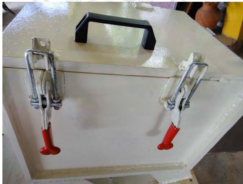
ภาพที่ 3-7 แสดงถังบีบที่ทำการเชื่อมประกอบแล้ว
