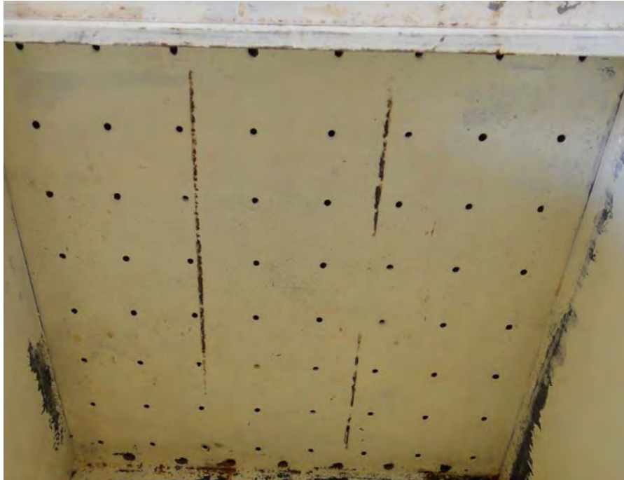
ภาพที่ 3-8 แสดงแผ่นรองถังบีบที่เจาะรูระบายน้ำ
