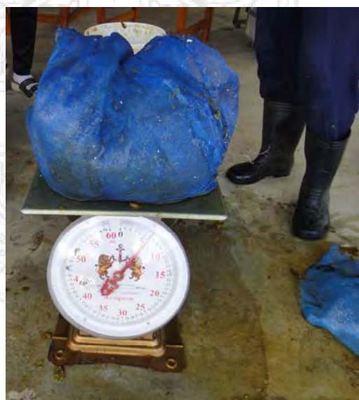
ภาพที่ 3-20 แสดงการนำเยื่อใบสับปะรดใส่ผ้าตาข่ายไนลอน
