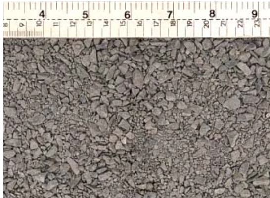
รูปที่ 1 : ลักษณะทั่วไปของหินฝุ่นหินปูน
