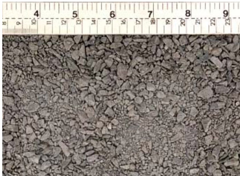
รูปที่ 5 : ลักษณะทั่วไปของหินฝุ่นหินปูน
