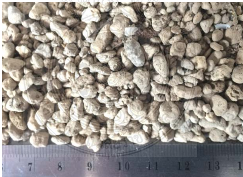
รูปที่ 6 : ลักษณะทั่วไปของหินพัมมิชผ่านตะแกรงเบอร์ 4
