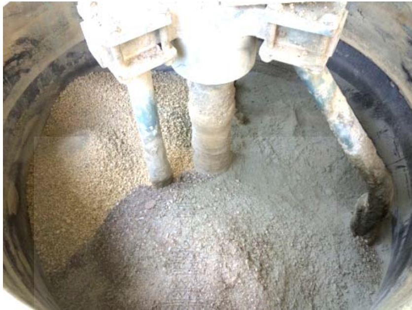
รูปที่ 8 : ผสมส่วนผสมทั้งหมดด้วยเครื่องผสมคอนกรีตแบบกระเทาะ
