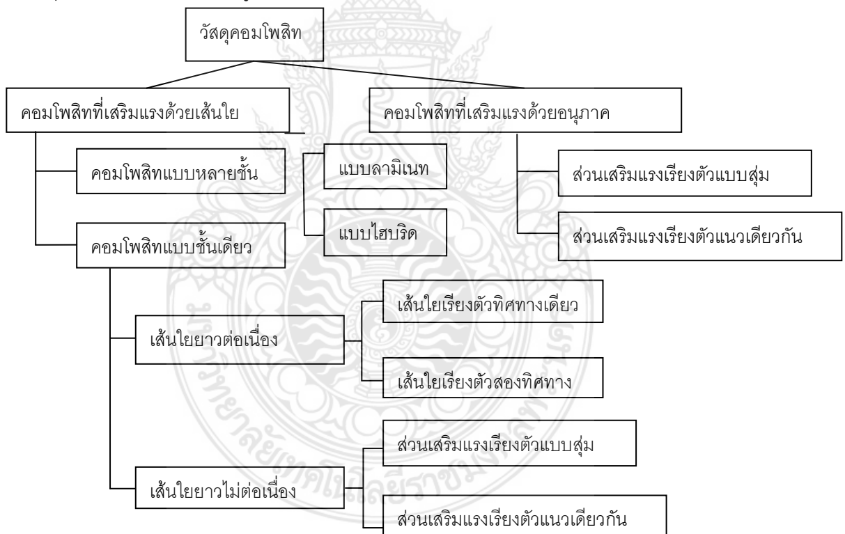
รูปที่ 2.1 แสดงประเภทของวัสดุคอมโพสิตโดยแบ่งตามลักษณะของส่วนเสริมแรง [3],[4]
