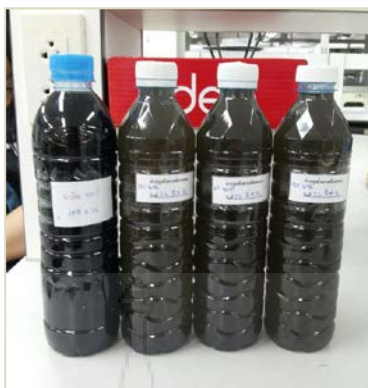
ภาพที่ 4.19 น้ำเสียความเข้มข้นร้อยละ 100 ที่ผ่านการดูดซับด้วยถ่านหุงต้ม
