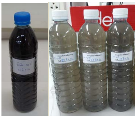
ภาพที่ 4.13 น้ำเสียความเข้มข้นร้อยละ 50 ที่ผ่านการดูดซับด้วยถ่านหุงต้ม
