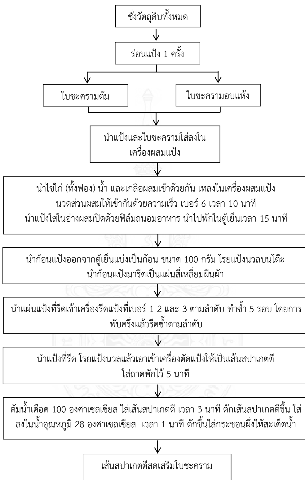
แผนภูมิที่ 3.3 ขั้นตอนการผลิตเส้นสปาเกตตีสดเสริมไบชะคราม
