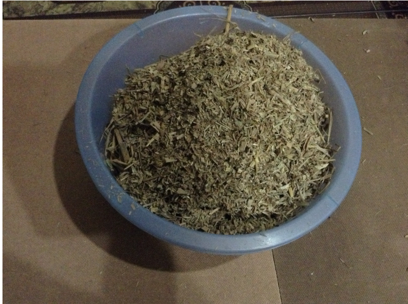
ภาพ ข 5 เส้นใยมะละกอที่บดเพื่อทำการปรับปรุงเยื่อ
