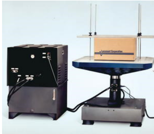
ภาพ ค 4 เครื่องมือทดสอบคุณสมบัติทางกายภาพ การต้านแรงสั่นสะเทือน
