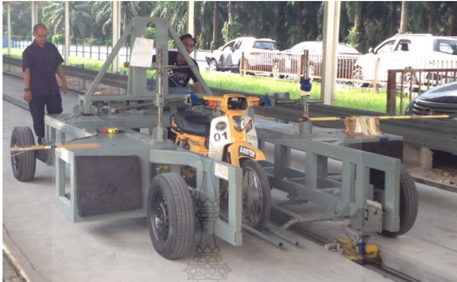
รูปที่ 2.5 ชุดขับเคลื่อนจักรยานยนต์เพื่อการทดสอบการชน [13]
