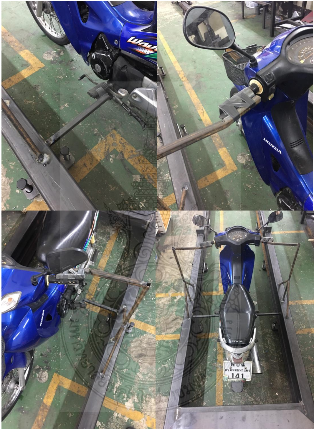
รูปที่ 3.9 การติดตั้งชุดแกนประคองรถทดสอบ
