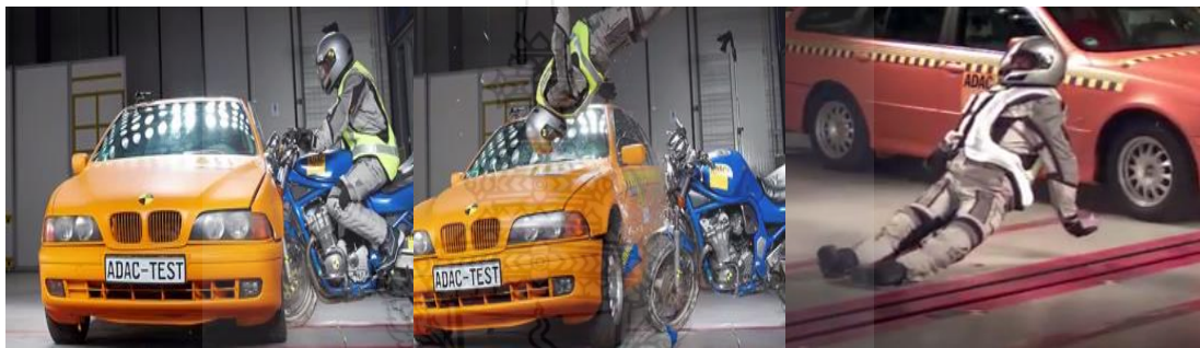
รูปที่ 2.1 การทดสอบการชนของจักรยานยนต์ที่ส่วนหน้าของรถยนต์ [9]
