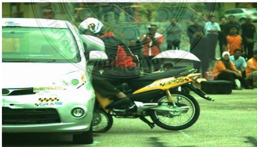
รูปที่ 2.4 การทดสอบการชนจักรยานยนต์รุ่นเล็กแบบเต็มสเกล [12]
