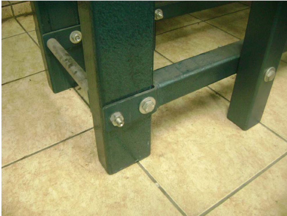
ภาพฐานเครื่องแสดงการยึดด้วยโบลท์สามารถถอดประกอบเครื่องได้
