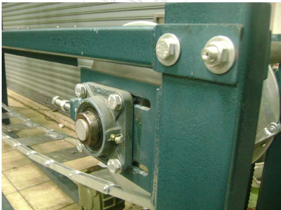
ภาพแสดงชุดปรับตั้งความตึงของสายพาน
