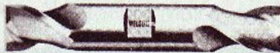
(ก) End Mill แบบสองคมตัดใช้กัดร่องหรือเจาะรูคล้ายดอกสว่าน
