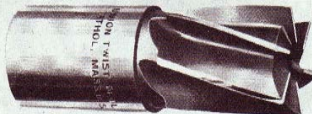
Straight-Shank Spiral End Mill เป็นดอก End mill ที่มีก้านตรงและมีพื้นคมตัดเอียง
