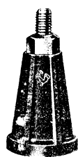
รูปที่ 5-19 เกสียวปรับรองรับชิ้นงาน (Vertical Jack)
