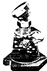
รูปที่ 5-18 เกสียวปรับรองรับชิ้นงาน (Jack Screw หรือ Standard Plane Jack)
