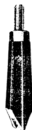
รูปที่ 5-20 เกสียวปรับรองรับชิ้นงาน (Bracing Jack)
