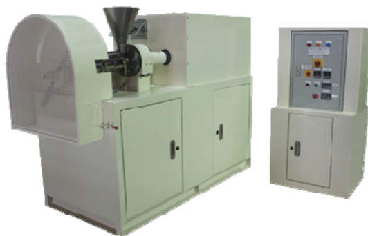
ภาพที่ 3 แสดงเครื่องอัดรีดชนิดสกรูเดี่ยว, Collet (รุ่น D50L300, บ. เจริญทัศน์)
