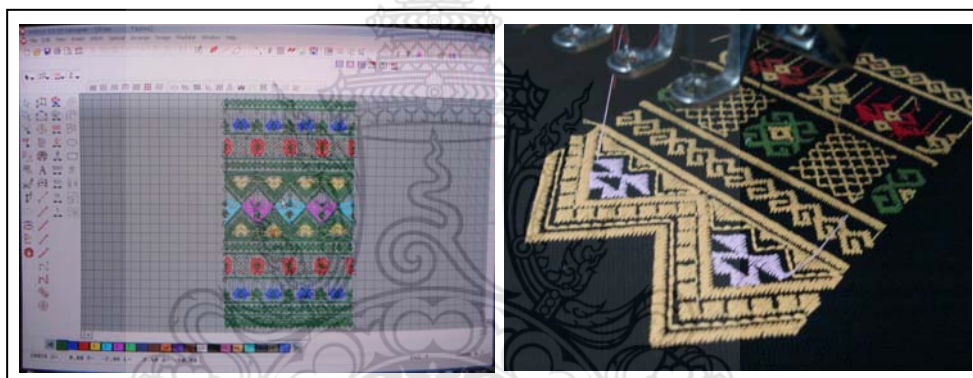
ภาพที่ 3.1 การตั้งค่าในคอมพิวเตอร์แล้วทดลองปัก
