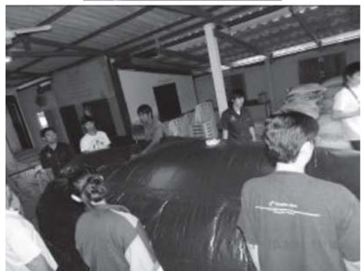
รูปที่ 7 แสดงทดสอบรอยรั่วด้วยไอเสียจากรถยนต์
