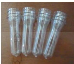
ภาพที่ 3-14 PREFORM (Preform) ขนาด 19g
