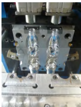
ภาพที่ 3-16 การใส่พรีฟอร์ม (Preform) ก่อนเป่า
