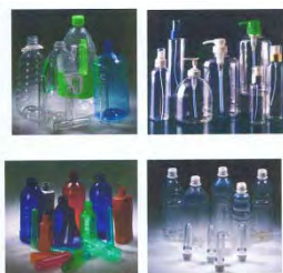
ภาพที่ 2-29 แสดงตัวอย่างผลิตภัณฑ์ที่ได้จากการขึ้นรูปโดยการเป่าPETและกรรมวิธีCSBM
