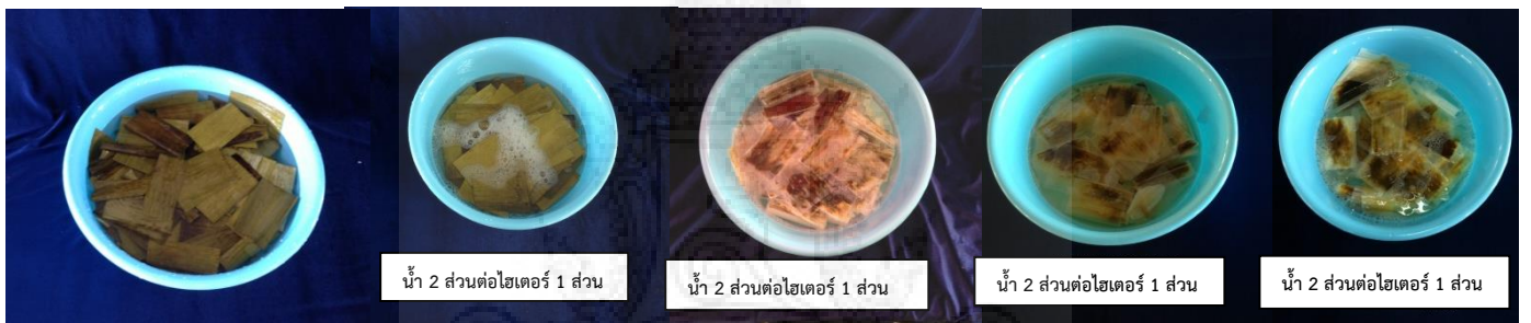
ภาพที่ 3.4 แสดงขั้นตอนการฟอกขาว สูตรที่ 2 น้ำ 2 ส่วนต่อไฮเตอร์ 1 ส่วน
