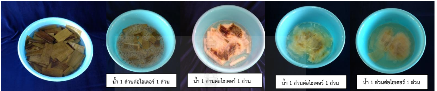
ภาพที่ 3.3 แสดงขั้นตอนการฟอกขาว สูตรที่ 1 น้ำ 1 ส่วนต่อไฮเตอร์ 1 ส่วน
