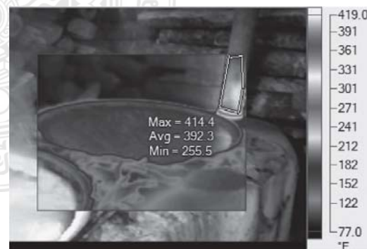
รูปที่ 11 ค่าเฉลี่ยอุณหภูมิของช่องระบายไอเสียของเตาปล่อง
