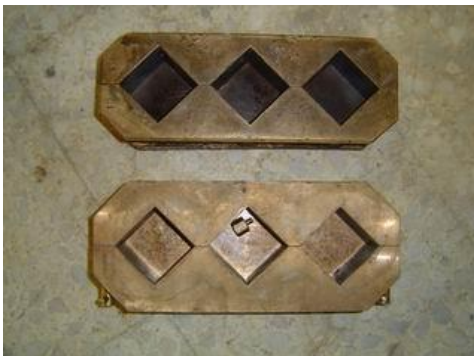
รูปที่ 2 แบบหล่อทองเหลือง ขนาดมาตรฐาน ASTM C 109/C 109 M-99
