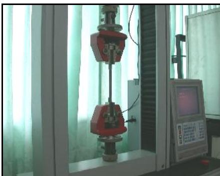
รูปที่ 7 การทดสอบแรงฉีก
