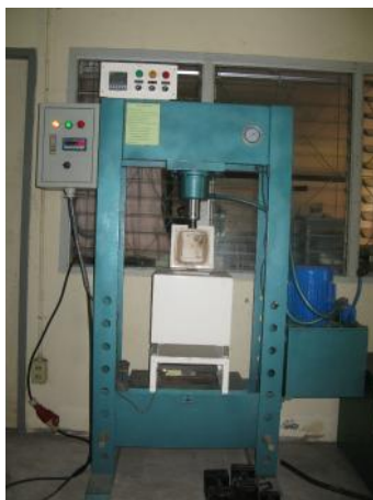
รูปที่ 2 เครื่องมืออุปกรณ์ในกรรมวิธีการเชื่อมโดยการแพร่
