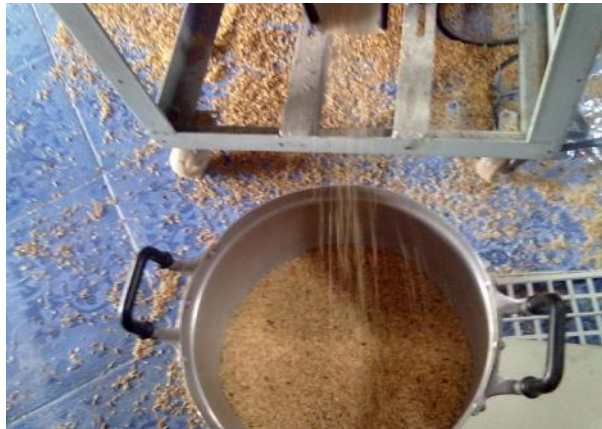
รูปที่ 12 การทำงานเครื่องสีข้าวกล็องขนาดเล็กสำหรับครัวเรือน
