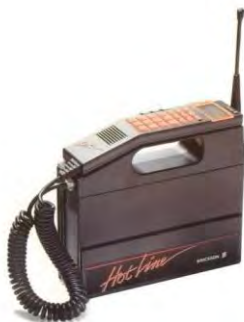
ภาพที่ 2.1 แสดงโทรศัพท์เคลื่อนที่แบบ Portable Set ใช้ระบบ NMT 450 เมกะเฮิร์ตซ์ ที่มา: เอ็นพีดี 9, มปป.
