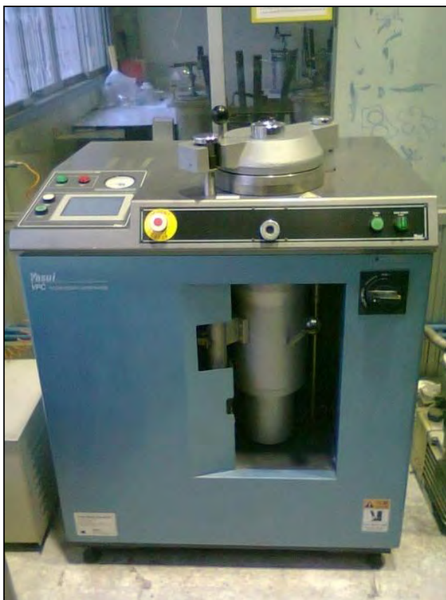
รูปที่ 3.7 เครื่องหล่อทดสอบสุญญากาศยี่ห้อ Yasui รุ่น K2
