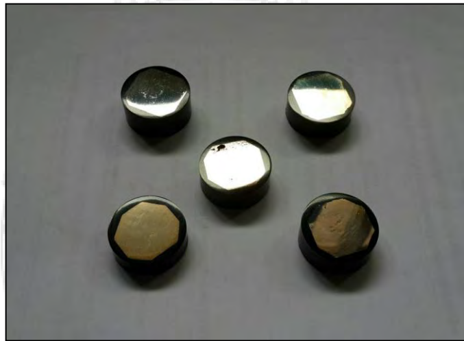
รูปที่ 3.10 ชิ้นงานทดสอบโลหะเงินเจือต่ำสำหรับวิเคราะห์คาร์บอน
