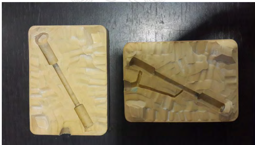
รูปที่ 3.4 โพรงแบบซิลิโคนสำหรับการฉีดขึ้นรูปตัวแบบเทียนสำหรับทดสอบความต้านแรงดึง
