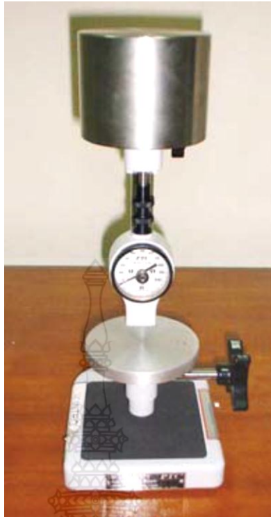
รูปที่ 20 เครื่องวัดค่าความแข็ง แบบ Shore D
