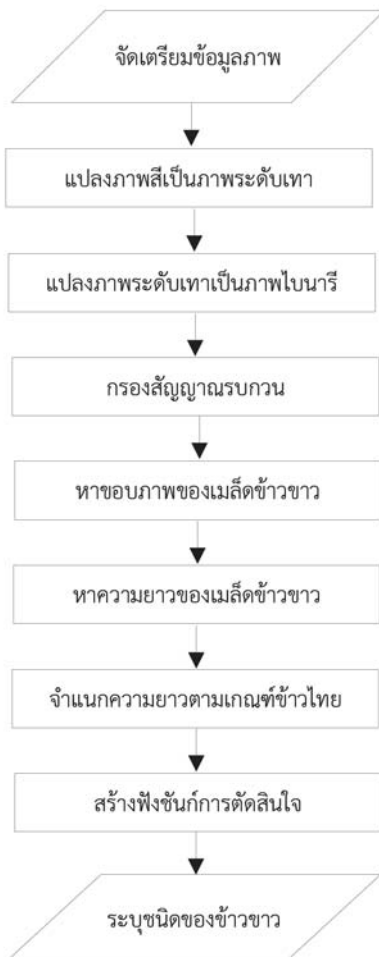
รูปที่ 1 แผนผังขั้นตอนการจำแนกชนิดข้าวขาว
