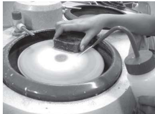
รูปที่ 7 การขัดชิ้นงานด้วยผงอลูมินา
