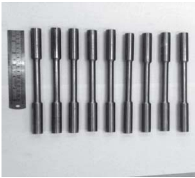
รูปที่ 4 ชิ้นงานทดสอบความแข็งแรงล้า
