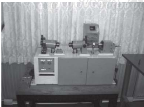
รูปที่ 5 เครื่องทดสอบความแข็งแรงล้าแบบคานหมุน
