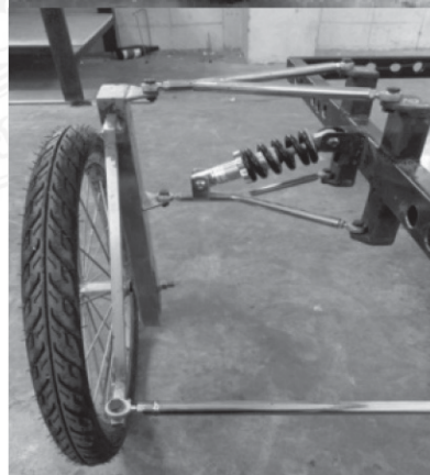
รูปที่ 4 แกนพวงมาลัย ระบบบังคับล้อ และเฟลา ล้อหน้า
