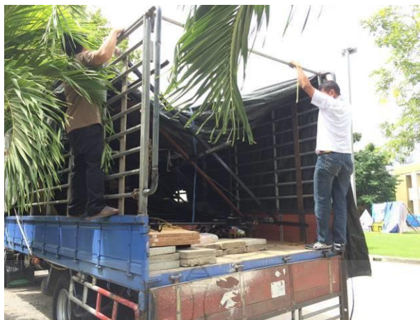
รูปที่ 4.32 การคลุมกระเบของรถบรรทุก 6 ล้อ ด้วยผ้าใบขณะทำการขนส่งโครงสร้างบ้านถอดประกอบ
