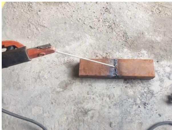
รูปที่ 3.21 การเชื่อมพอกให้กับรอยต่อของเหล็กรูปพรรณหน้าตัดสี่เหลี่ยมผืนผ้า
