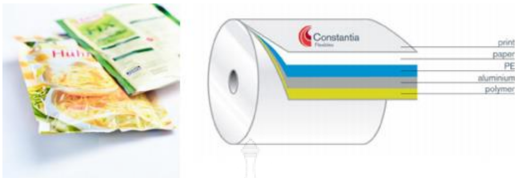
รูปที่ 2.14 การเคลือบลามิเนตบรรจุภัณฑ์อาหารสำเร็จรูป ที่มา : constantia-flexibles (2016)
