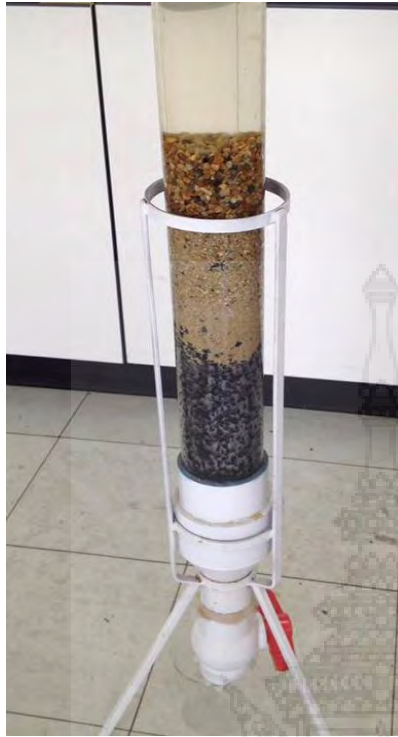
รูปที่ 3.8 การกรองน้ำเสียผ่านวัสดุตัวกรอง
