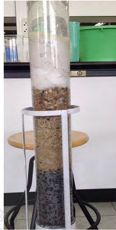
รูปที่ 3.8 การกรองน้ำเสียผ่านวัสดุตัวกรอง
