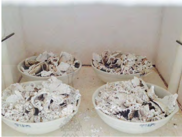
รูปที่ 3.5 การเผาเปลือกหอยในเตาเผาที่อุณหภูมิ 900 องศาเซลเซียส
