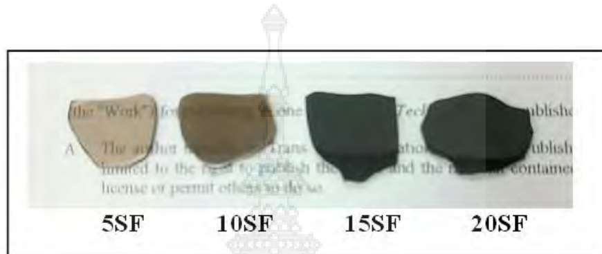
รูป 4.3 ลักษณะทางกายภาพของชิ้นงานแก้วชีวภาพที่ประกอบด้วยสารเฟอร์โรแมกเนติกที่ผ่านการหลอมด้วยเงื่อนไขต่างๆ
