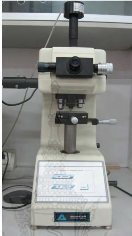
รูป 3.12 เครื่องวัดความแข็ง Micro-Vickers hardness testing รุ่น Mitutoyo Model: MVK-H3
