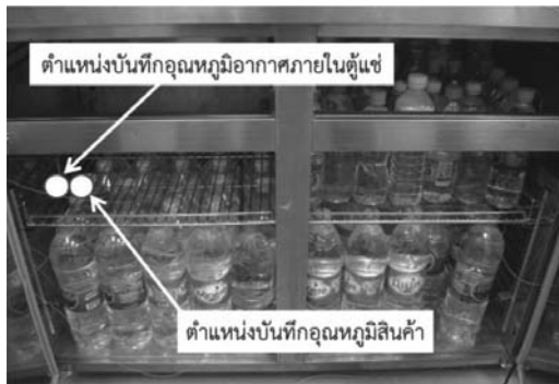
รูปที่ 2 ตำแหน่งติดตั้งสายวัดอุณหภูมิอากาศและอุณหภูมิลินค้ำภายในตู้แช่
