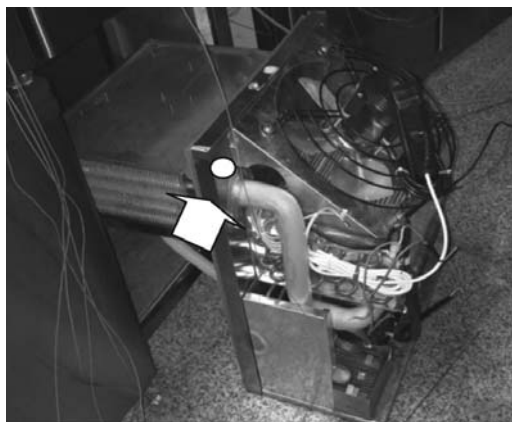
รูปที่ 3 ตำแหน่งติดตั้งสายวัดอุณหภูมิที่เครื่องระเหย
