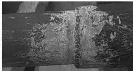
รูปที่ 7 การกัดกร่อนของเพลابرเวณรอยเชื่อม
