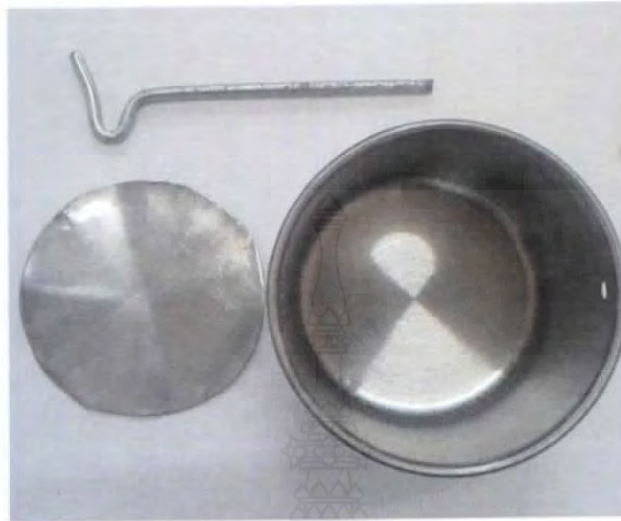
ภาพที่ ก.6 พิมพ์ขึ้นรูปสแตนเลสรูปทรงกระบอก ขนาดเส้นผ่านศูนย์กลาง \times ความยาว คือ 7 \times 6 เซนติเมตร
