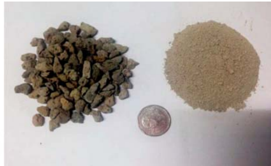
รูปที่ 1 มวลรวมหินพัมมิชด้านซ้ายและเถ้าเถ้าขี้เถ้าปาราด้านขวา
