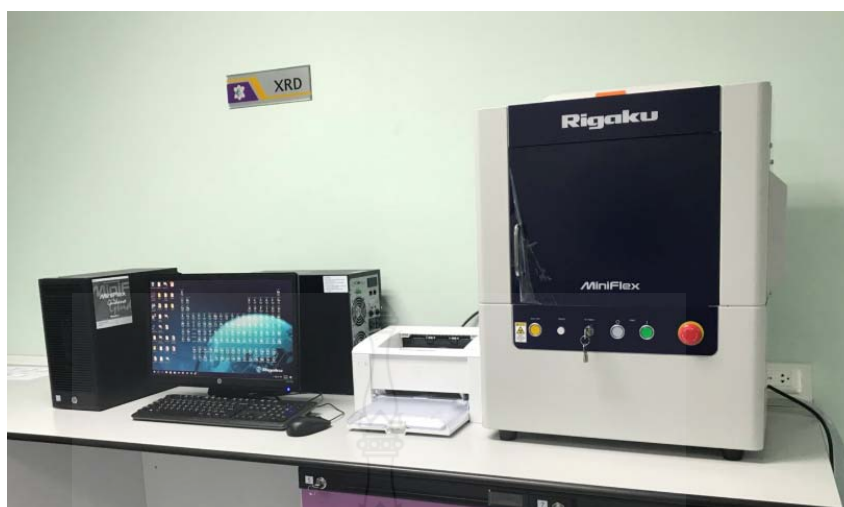
รูปที่ 3.8 เครื่องวิเคราะห์การเลี้ยวเบนรังสีเอกซ์ X-ray Diffractometer (XRD)
