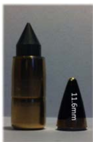
รูปที่ 2.11 รูปแบบกระสุนที่ใช้ในการทดสอบ [28]
