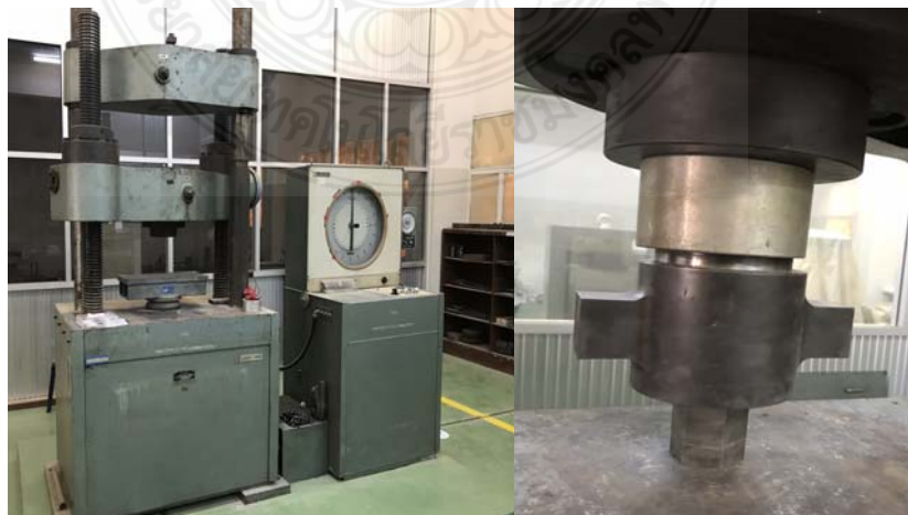
รูปที่ 3.12 เครื่อง Universal Testing Machine: (UTM) แบบควบคุมด้วยมือ
