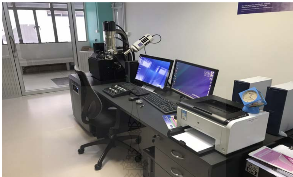
รูปที่ 3.7 กล้องจุลทรรศน์อิเล็กตรอนแบบส่องกราด Scanning Electron Microscope: (SEM) และ Energy Dispersive X-Ray Spectrometer: (EDS)
