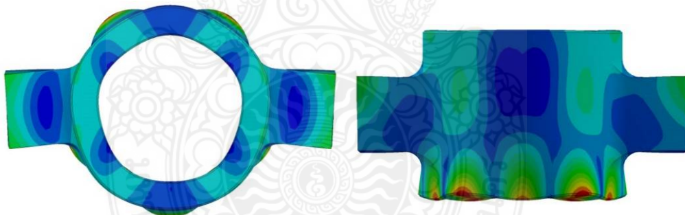
รูปที่ 4.12 Natural Frequency ที่ Mode Shape No.9: 26.164 kHz [62]
