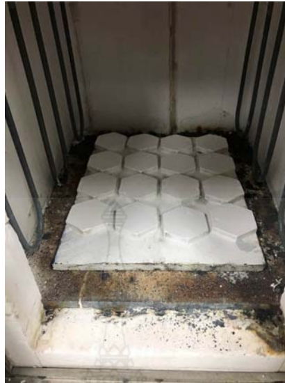
รูปที่ 4.38 การจัดวางเรียงชิ้นงานในเตาเผาผนัง
