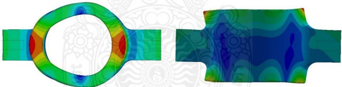
รูปที่ 4.5 Natural Frequency ที่ Mode Shape No.2: 22.096 kHz [62]
