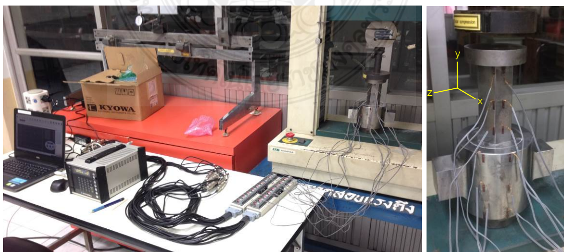
รูปที่ 4.16 การติดตั้ง Strain Gage ลงบนตัวเรือนแม่พิมพ์และแกนอัด
