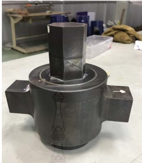
รูปที่ 3.10 แม่พิมพ์สำหรับการอัดขึ้นรูปชิ้นงาน
