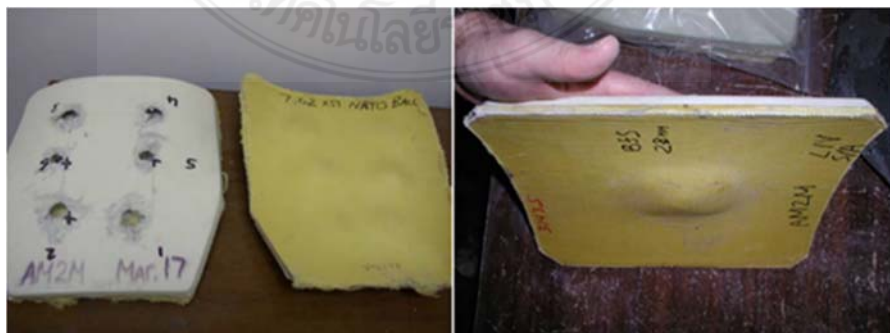
รูปที่ 2.7 ผลการทดสอบยิงเกราะเซรามิกส์อลูมินา-มัลไลต์ AM2 (ก) กระสุน 7.62x51 mm NATO Ball FMJ (6 รู้นี้ไม่ทะลุ) (ข) 7.62x63 mm AP M2 (1 รู้นี้ไม่ทะลุ) [21]
