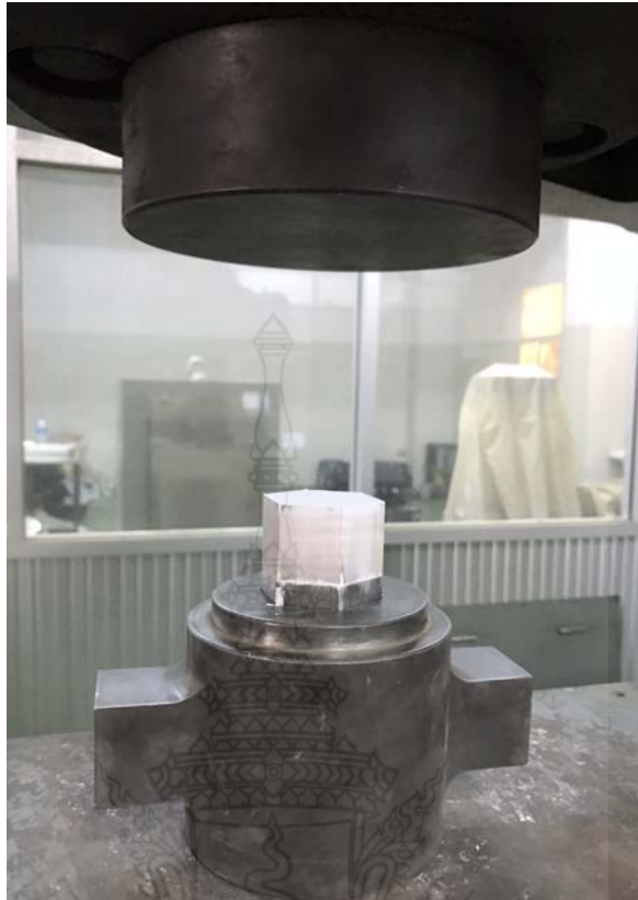
รูปที่ 3.13 ชิ้นงานที่ได้หลังจากกระบวนการอัดขึ้นรูป
