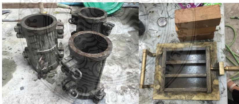
ภาพที่ 2 แบบหล่อคอนกรีต
