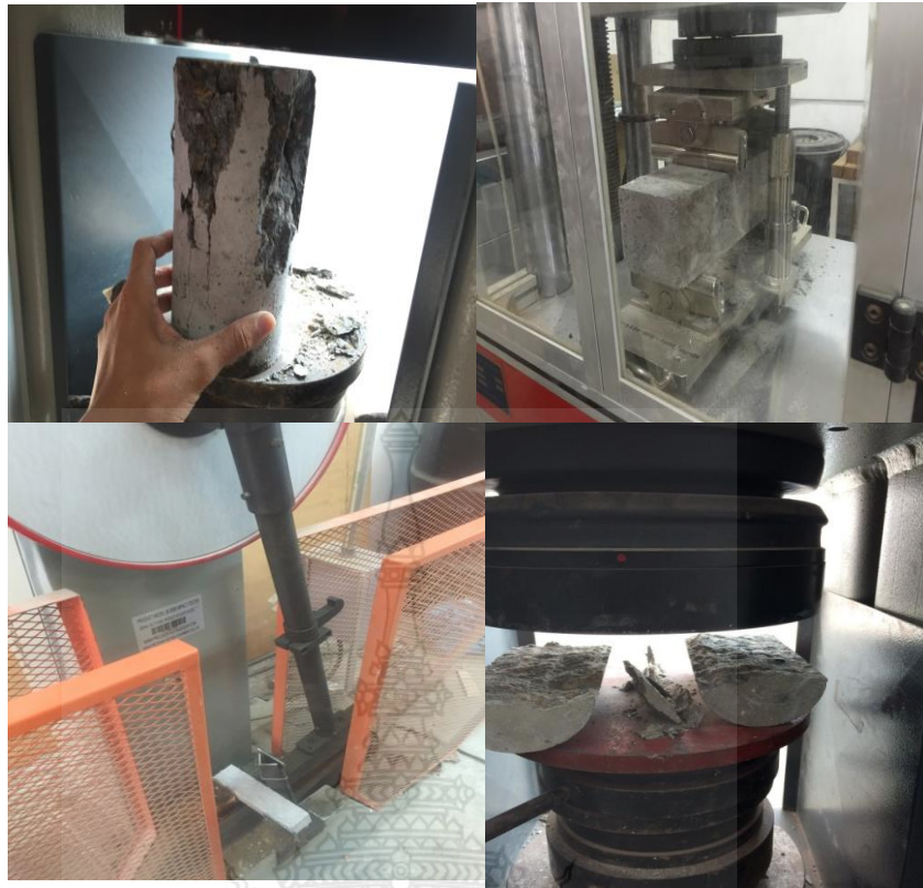
รูปภาพที่ 4 การทดสอบกำลังอัดของคอนกรีตรูปทรงกระบอก
