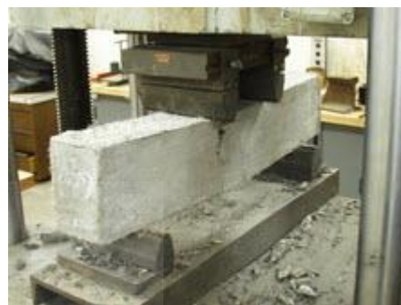
ภาพที่ 3.6 ภาพตัวอย่างการทดสอบกำลังรับแรงดัดของคอนกรีตตามมาตรฐาน ASTM C78-94 (Flexural Test)
