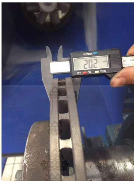
รูปที่ 3.7 การตรวจวัดความหนาของจานเบรก
