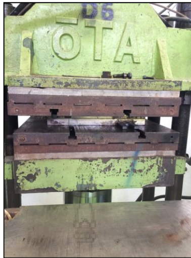
ภาพที่ 19 แสดงการตรวจสอบระบบการทำงานของเครื่องอัดขึ้นรูปยาง
