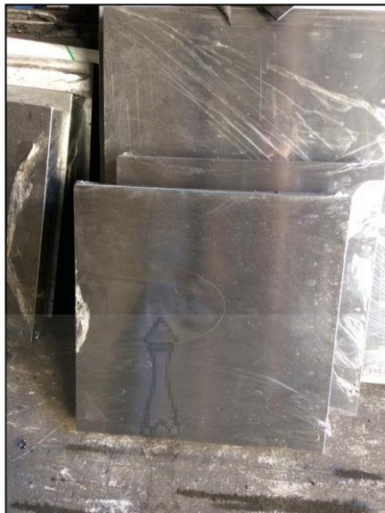
ภาพที่ 7 แสดงวัสดุเหล็กกล้าคาร์บอนที่นำมาสร้างแม่พิมพ์
