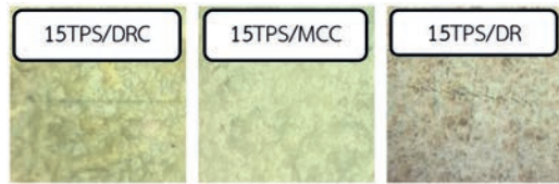
รูปที่ 8 ลักษณะพื้นผิวของฟิล์มคอมโพสิต 15TPS/DRC 15TPS/MCC และ 15TPS/DR ที่อัตราส่วน 80/20 ด้วยกล้องจุลทรรศน์แบบสเตอริโอกำลังขยาย 4 เท่า (4X)
