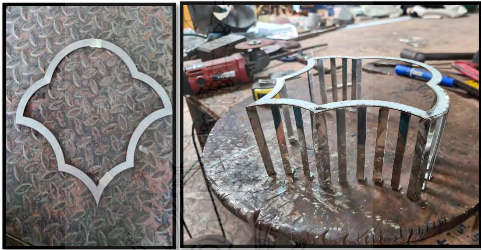
ภาพที่ 3.43 ขั้นตอนการขึ้นรูปชิ้นงานโคมไฟติดผนัง
