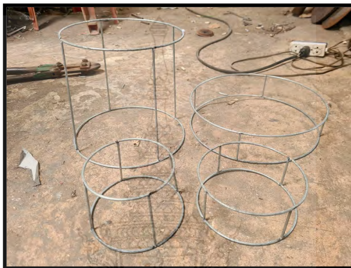
ภาพที่ 3.37 ขั้นตอนการขึ้นรูปชิ้นงานโคมไฟแขวน
