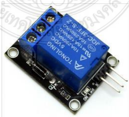
ภาพที่ 2-12 แสดงภาพโมดูลรีเลย์สำเร็จรูป 1 ช่อง ใช้แรงดัน 5V
