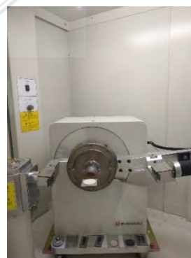
ภาพที่ 3.6 (ข) การวัดค่าการเลี้ยวเบนของรังสีเอ็กซ์
