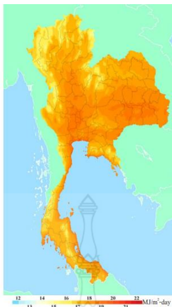
รูปที่ 2.1 แผนที่ศักยภาพพลังงานแสงอาทิตย์เฉลี่ยตลอดปี (การกระจายของรังสีอาทิตย์รายวันเฉลี่ยต่อปี) ที่มา: กรมพัฒนาพลังงานทดแทนและอนุรักษ์พลังงาน. [1]
