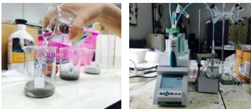
รูปที่ 2 การหาปริมาณคลอไรด์ด้วยเครื่องวัดคลอไรด์อัตโนมัติ
