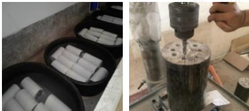
รูปที่ 1 การแยกละลายโซเดียมคลอไรด์และการเก็บผงตัวอย่างคอนกรีต
