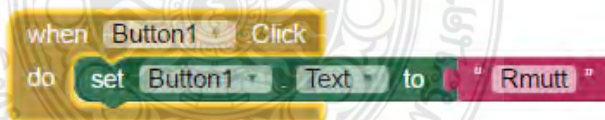
รูปที่ 2.9 บล็อกคำสั่งประเภทเหตุการณ์ (Event Handler)
