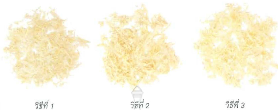
ภาพที่ 4.19 เส้นใยจากใบอ้อยที่ผ่านการแยกด้วย NaOH 20 กรัมต่อลิตร
