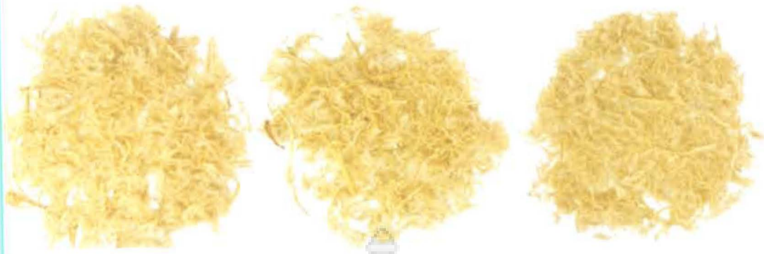
ภาพที่ 4.13 เส้นใยจากใบอ้อยที่ผ่านการแยกด้วย NaOH 8 กรัมต่อลิตร
