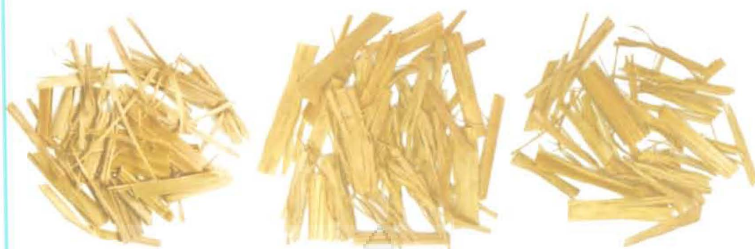
ภาพที่ 4.10 เส้นใยจากใบกล้วยที่ผ่านการแยกด้วย NaOH 2 กรัมต่อลิตร
