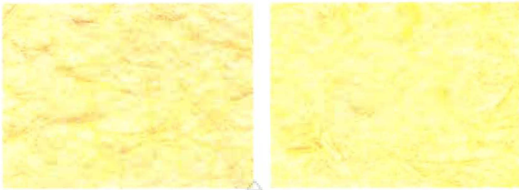
ภาพที่ 4.20 ลักษณะของแผ่นเส้นใยที่ผ่านการยึดติดกันด้วยสารละลาย พอลิไวนิลแอลกอฮอล์ที่ความเข้มข้นต่างๆ
