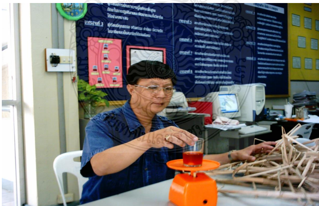
ภาพที่ 6 ชั่งน้ำหนักกาวฟีนอลไซยาเนตในปริมาณ 8%ต้นสับู่ดำ 92 %
