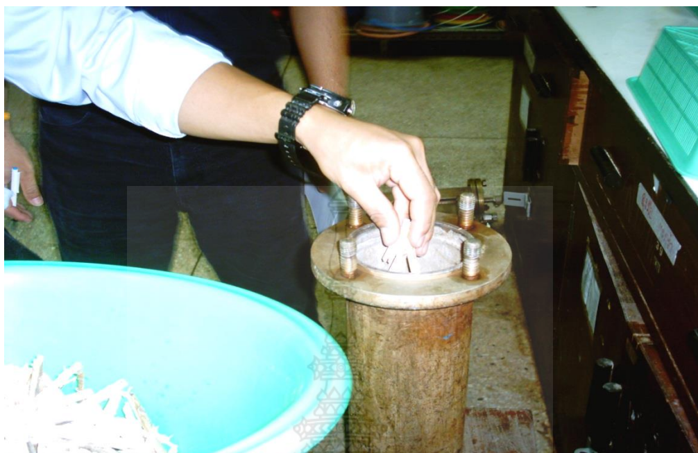
ภาพที่ 31 นำเอาต้นสบูดำที่ตากแห้งแล้ว ประมาณ 200กรัม ไปใส่ในหม้อต้ม
