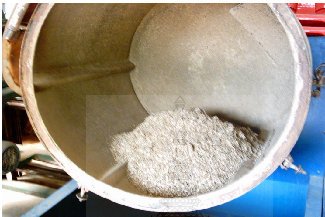
ภาพที่ 7 น้ำตั้นสบูดำ ใส่ลงเครื่องคลุกผสม
