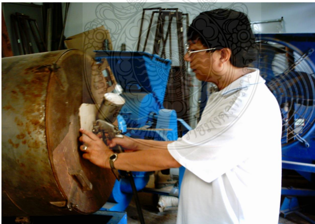
ภาพที่ 8 ฉีดพ่นกาวไอโซไซยาเนตในเครื่องคลุกผสม
