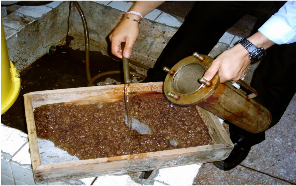
ภาพที่ 37 นำเยื่อที่ได้ไปล้างเพื่อเอากากออก และแช่น้ำเพื่อให้อุณหภูมิลดลง
