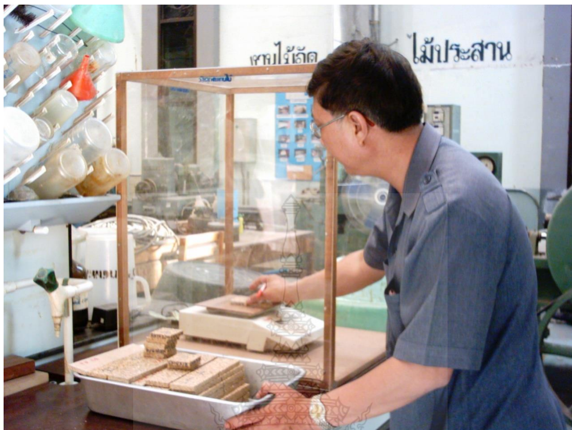
ภาพที่ 17 ชั่งน้ำหนักของแผ่นทดสอบเพื่อหาค่าความชื้นและความหนาแน่น (ความชื้นต้องอยู่ในช่วง 4-13%)
