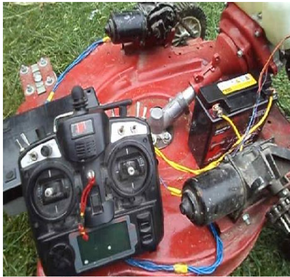
รูปที่ 13 รถตัดหญ้าบังคับวิทยุที่ใช้เครื่องยนต์แบบเครื่องตัดหญ้าสะพายบ่าเป็นต้นกำลัง
