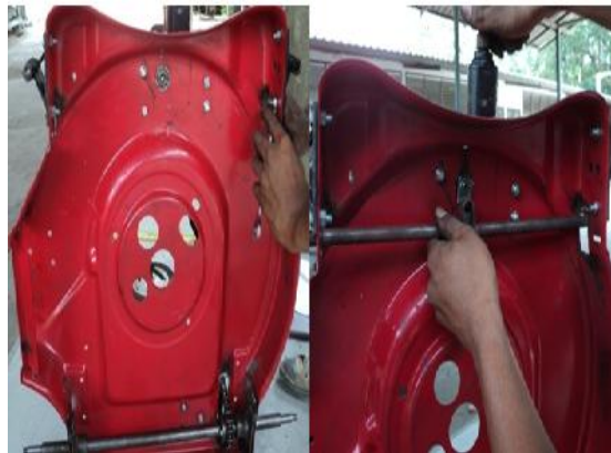
รูปที่ 2 คั่นชกกับแขนเลี้ยวและระบบขับเคลื่อนด้วยเฟลาที่ออกแบบใหม่
