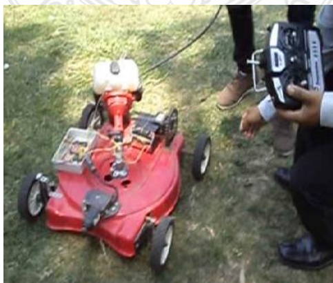
รูปที่ 6 ตัวรถพร้อมติดตั้งเครื่องตัดหญ้าแบบสะพายป่าระบบขับเคลื่อนแบบที่ 1
