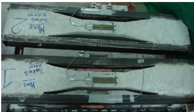
รูปที่ 5 ตำแหน่งที่วัดความเครียดในคอนกรีตและโครงเหล็ก
